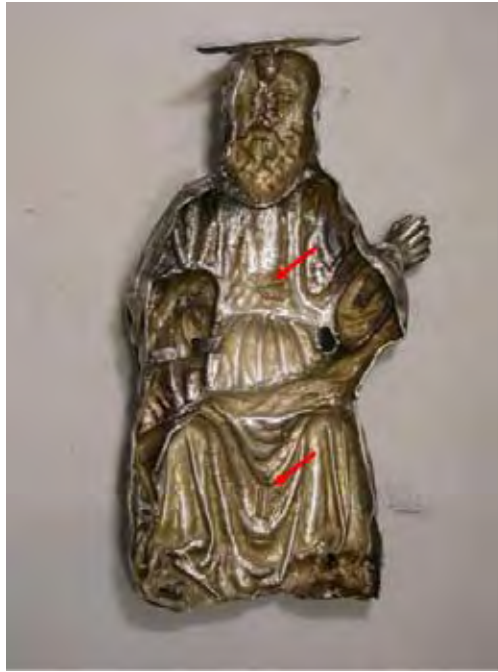
Fig. 3: sul retro della figura del Cristo Benedicente, distaccata prima del restauro, sono evidenti le saldature ed i residui delle linguette, ora perdute, che costituivano l'aggancio a farfalla sulle lamine della Croce.
